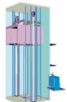
Doble-cilindro colocación lateral 6-vía tipo 2:1
