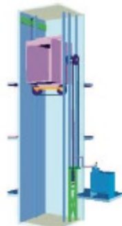
Mono-cilindro colocación lateral tipo 4:2
